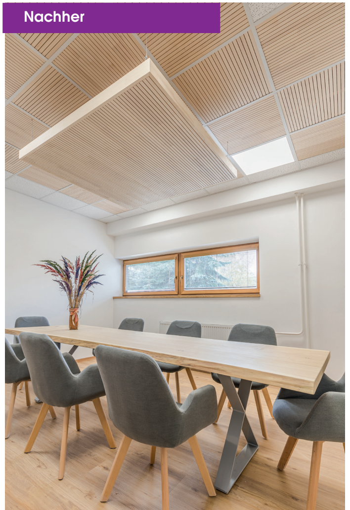
Weißtanne Akustik-Einhängekassetten mit abwechselnd versetzten Akustiknuten, weißer Umrandung und mittigem Akustiksegel
