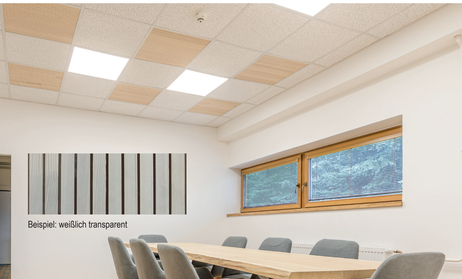
Weißtanne-Einhängeakustikkassetten mit abwechselnd versetzten Akustiknuten und weißer Umrandung.
